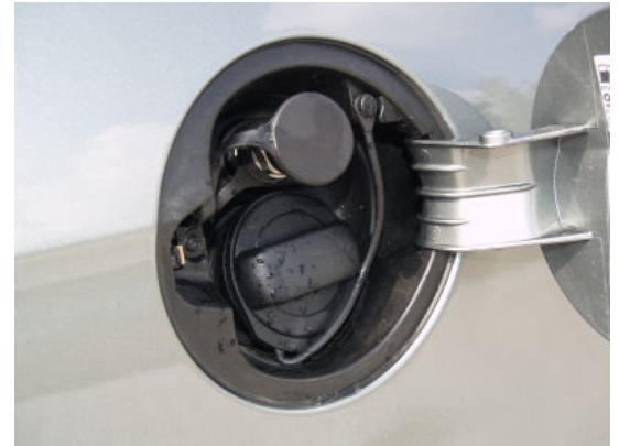
Der kombinierte Befüllanschluss für Erdgas und Benzin befindet sich unter der Serientankklappe.
